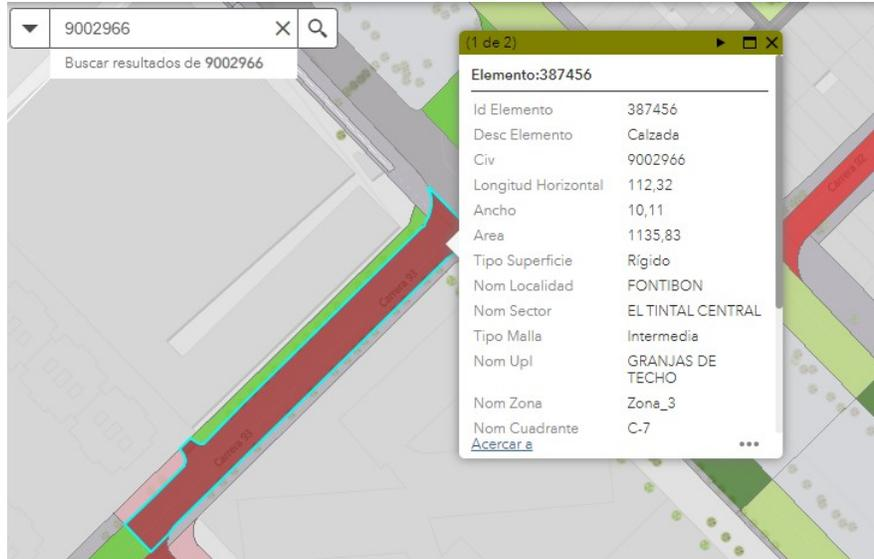
**Imagen 01** Información Tomada del Sistema de Información Geográfica Misional y de Apoyo (SIGMA). Ancho promedio de 9.0m. Se evidencia blacktopping un en área del segmento. La Intersección norte se encuentra en pavimento flexible (6.7m x 9.0m). Requiere actividades de rehabilitación. Estado Suspendingo.
