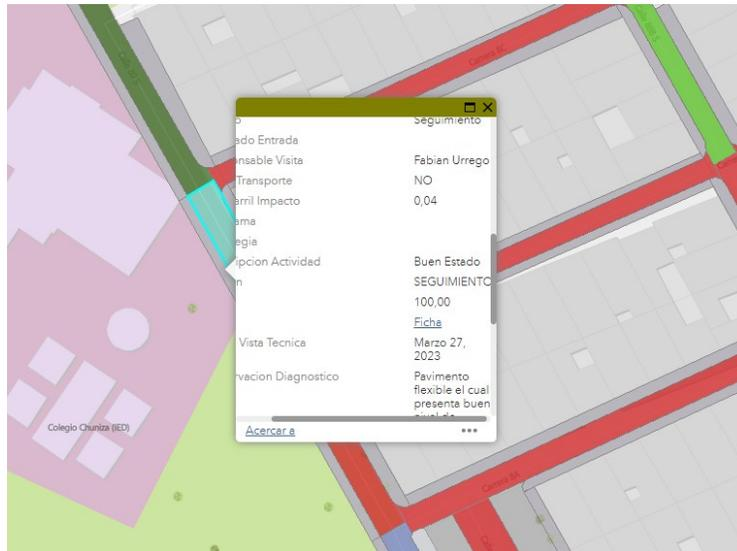
**Imagen 01** “(...) Pavimento flexible el cual presenta buen nivel de servicio, ancho medido 4.5 m (...)”, información Tomada del Sistema de Información Geográfica Misional y de Apoyo (SIGMA)
